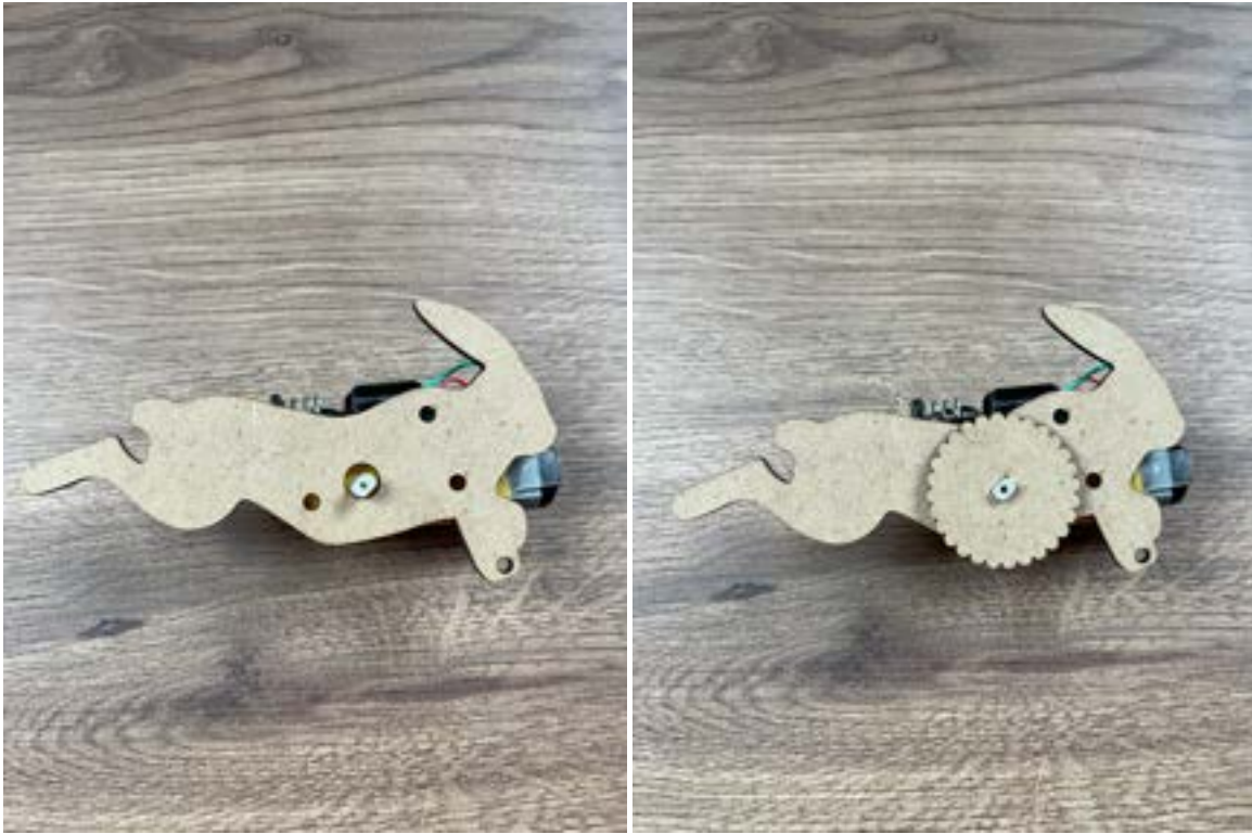
Şekil 6.3: Ahşap parçaların motora montajı
